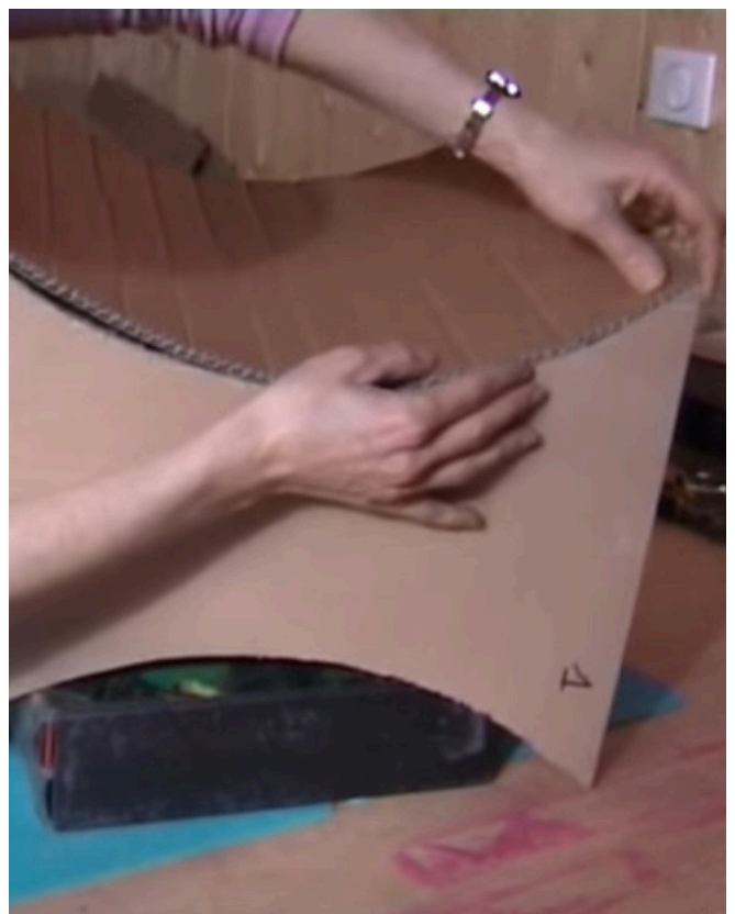
19) A l'aide de carton ondulé et de colle chaude, recouvrir les parties courbes
