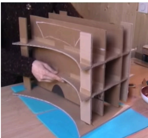
19) A l'aide de carton ondulé et de colle chaude, recouvrir les parties courbes
