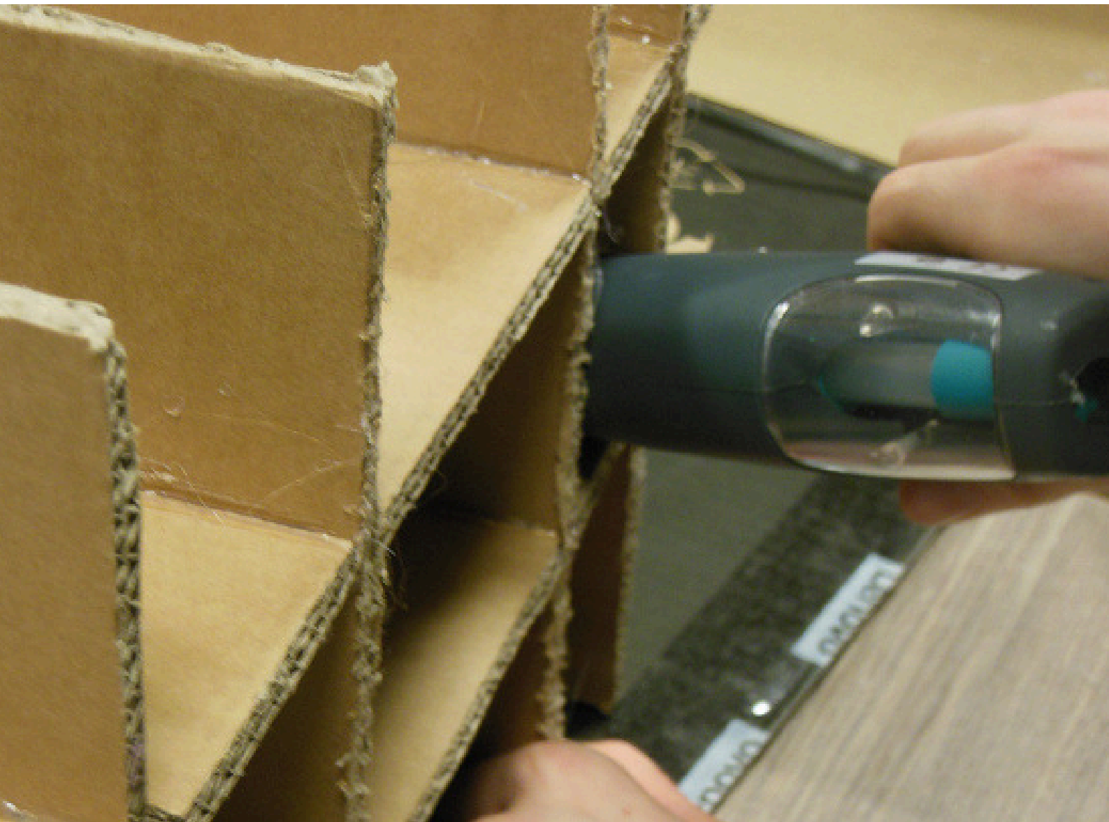
17) Coller à l'aide d'un pistolet à colle l'ensemble des traverses
